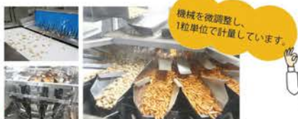
ピーナッツが酸化しないように、窒素ガスで密閉されたボックス内で計算されている。
