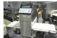
金属探知機通過 金属探知機で異物の危険性を取り除き、梱包となります。
