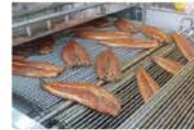
蒲焼き・タレ漬け・焼き工程×4回 焼きはガス火と、ポイントで炭火が入っており、遠赤外線効果で、ジューシーに仕上げる。
