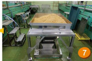
[7] 落とし込み 煮豆を充填工程へ落とし込む。
