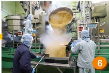
[6] ホッパー移送 納豆菌を噴霧しながら煮あがった大豆を ホッパーに落とし込む。
