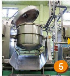
[5] 蒸煮 圧力釜で大豆を高圧・高温で 煮る。
