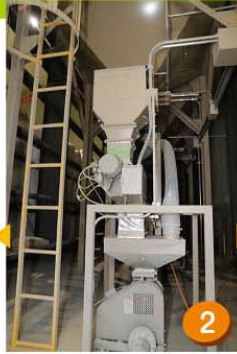
[2] 計量 サイロを通して大豆を計量し、 洗浄工程へ送り込む。
