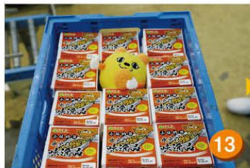
[13] 梱包 包装後の商品を45パックずつ コンテナへ収納する。
