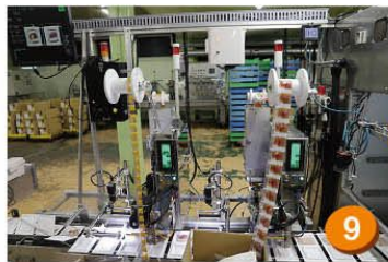
[9] たれ・からし投入 たれとからしを容器へ投入する。
