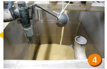
[4] 浸漬 洗浄後の大豆を一定時間浸漬する。
