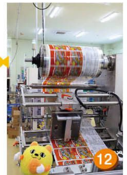
[12] 包装 個包装ラベルに賞味期限を印字し、 包装する。
