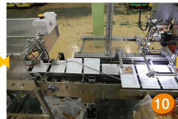
[10] 溶着 容器本体と蓋を熱溶着により密封する。
