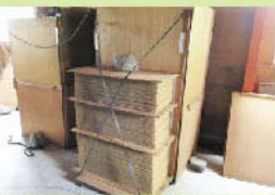
大きな扇風機が設置された箱の中から風がでてきて乾燥させます。
