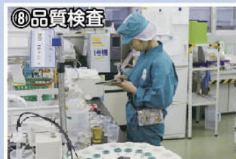
⑧ 品質検査 酸度などの機器分析に加え、ヒトによる官能検査を実施し、品質を確認します。
