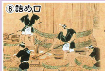
⑧ 詰め口 ろ過されたお酢を、納約と樽詰漏斗を使って、樽に入れます。樽の天面を木槌でたたき、音を聞くことで、入っているお酢の量を確認しながら行います。
