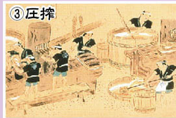
③ 圧搾 もろみを酢袋に入れ、槽で圧搾して絞ります。この、もろみから搾り出された液が、「酢もと(お酒)」です。
