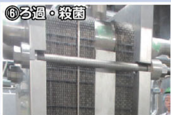
⑥ ろ過・殺菌 熟成を終えたら、味・きき・香りを損なわないように、ろ過・殺菌をします。
