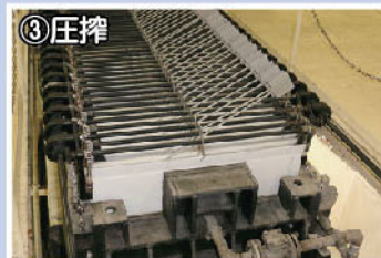
③ 圧搾 液化・糖化してできたもろみを、圧搾機で固液分離します。
