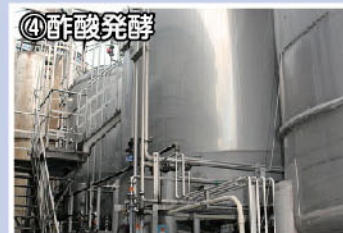
④ 酢酸発酵 圧搾して得られた液に、種酢、醸造用アルコール、水を加え、酢酸菌による発酵を行います。
