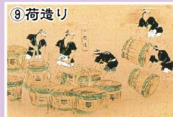
⑨ 荷造り 出荷前に樽の満量までお酢を注ぎ足してから、樽を縄で縛り、いよいよ製品となります。
