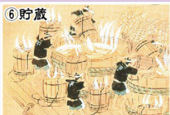
⑥ 貯蔵 できあがったお酢の半分を1階の貯蔵桶に移し、味をまろやかにするために、2~3ヶ月ほど寝かし熟成させます。なお、仕込み桶に残したお酢は、種酢として次の仕込みに使われます。
