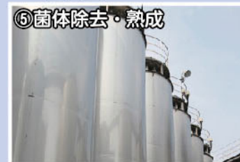
⑤ 菌体除去・熟成 酢酸発酵した液を、ろ過し、酢酸菌を取り除いた後、一定期間熟成させます。
