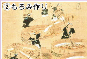
② もろみ作り 熟成した酒粕を桶に移し、水を加えかきまぜます。約1週間で「もろみ」ができあがります。
