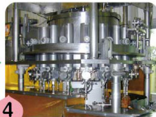
4 固形、液を分けて一定量を充填(容器に中身を詰めること)します。
