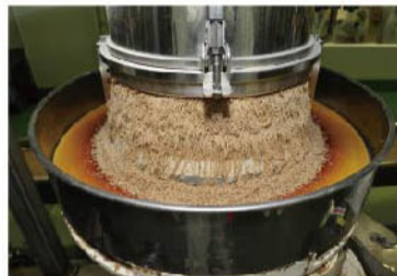
ほんだし工場に運ばれたかつおぶしは、1mm以下に細かくし、コク味やうま味など天然素材から作られた調味料を配合した後、顆粒にして乾燥させます。
