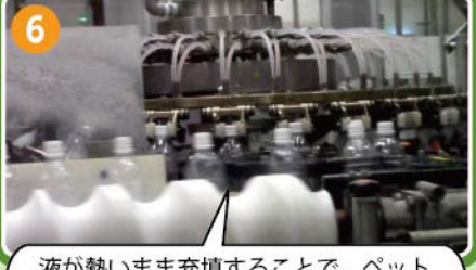
液が熱いまま充填することで、ペットボトル内の殺菌も同時に行います。
