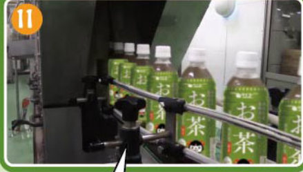
ラベルをペットボトルの形にぴったり合わせます。
