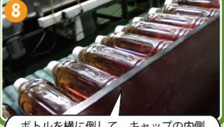
ボトルを横に倒して、キャップの内側まで殺菌します。
