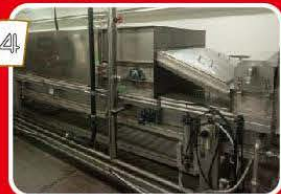
4 トネル状の蒸機の中で、麺に熱い蒸気当てて蒸します。麺の中のでんぷんを体の中で消化しやすい状態に変えます。
