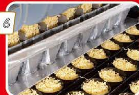
6 麺を食べやすい長さにした後、1食分ずつ金属製の型枠の中に入れ、約160度の植物油で揚げ、中の水分をはじき出して乾燥します。
