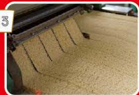
3 薄くした麺生地を、回転する切刃で1本1本の細い麺に切り分けます。
