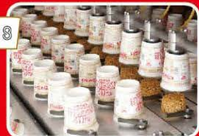
8 麺の上からカップをかぶせて反転させ、麺をカップの中に入れます。
