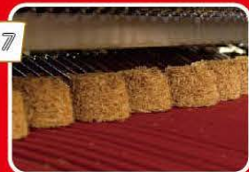
7 油で揚げた麺は熱くなっているため、風を吹き付けて冷まします。
