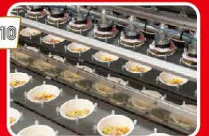
10 フタ(アルミキャップ)をカップの上に乗せ、約150度の熱で密封します。そしてカップ全体を薄い透明なフィルムで覆い、箱詰めして出荷されます。
